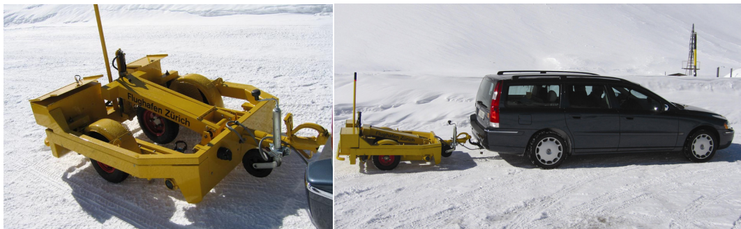
Abb. 3.1 Skiddometer BV 11 mit Zugfahrzeug
