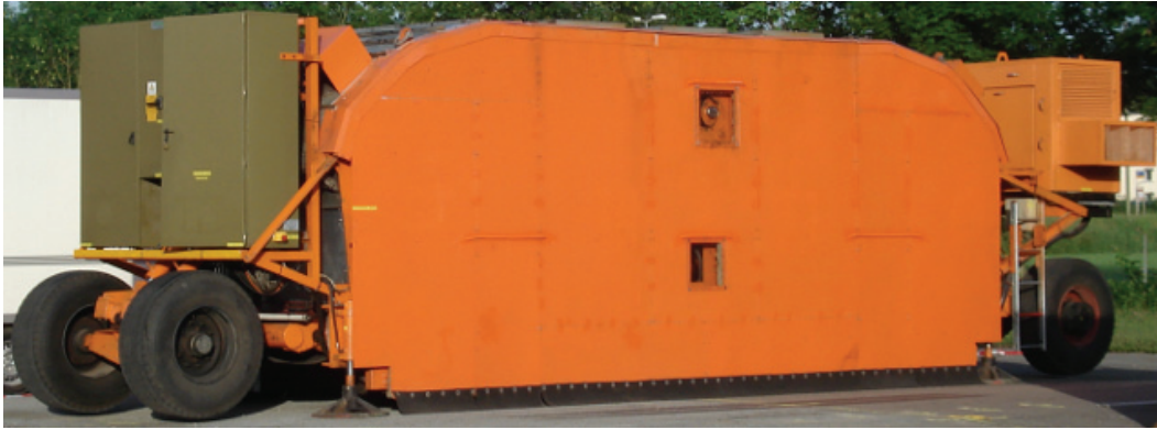
Abb. 6.39 Verkehrslastsimulator MLS10 (Dynamic Mobile Load Simulator, Verkehrslastsimulation im Massstab 1:1, EMPA)
