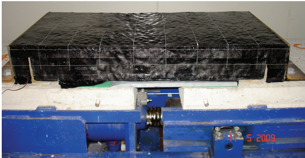
Abb. 6.42 Joint Movement Simulator JMS zur Untersuchung des Verhaltens bei tiefen Temperaturen (EMPA)
